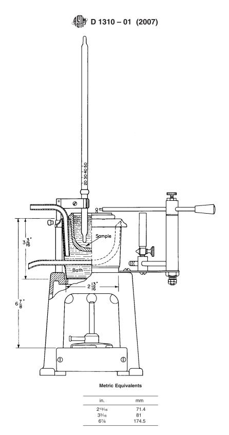
FIG. 1 Tag Open-Cup Apparatus
